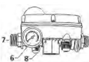
Блок управления АКВАРОБОТ ТУРБИПРЕСС состоит из пластикового корпуса, внутри которого установлены датчик давления, датчик потока и печатная плата с микроконтроллером. На корпусе установлен манометр ⑥ для визуального контроля величины давления в системе. Устройство имеет два присоединительных резьбовых патрубка ⑦, а
